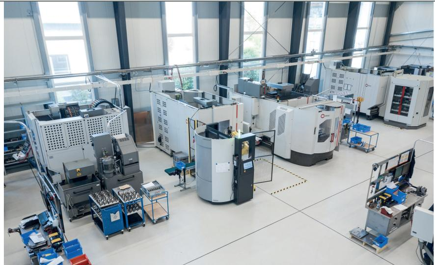
**Die Zuverlässigkeit steht bei Eroform in Reih und Glied (von links):** die C 12 U für die Einzelteilerfertigung, eine C 22 U mit Fremdautomation, eine C 40 mit Palettenwechsler und eine C 22 U mit dem Indunorm-Handlingsystem © Hermle
