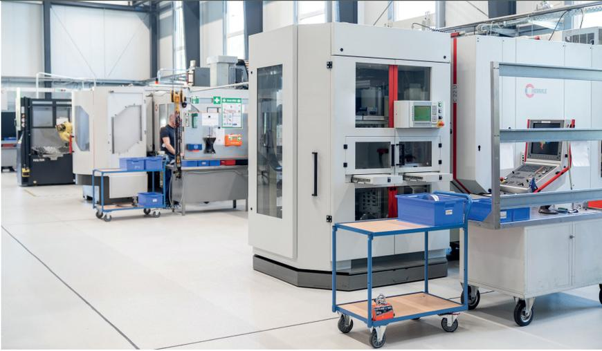
**Das Indunorm-Handlingsystem an der C 22 U (vorn im Bild) fasst bis zu 24 Paletten**
