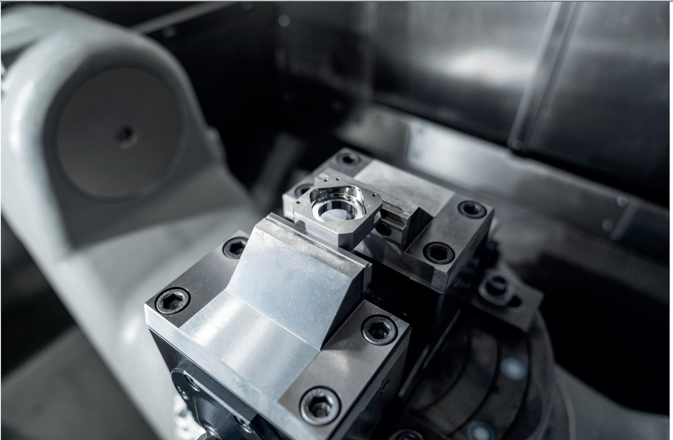
**Formenbauteile fünfachsig bearbeitet:** Je nach Komplexität benötigt die C 12 U bei Eroform für ein Bauteil 15 bis 60 Minuten
